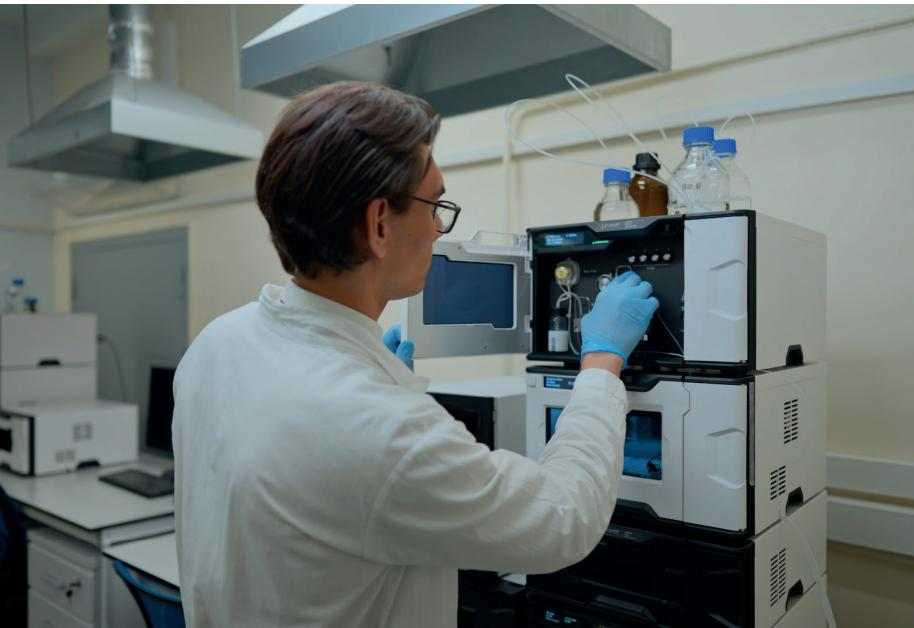
хроматографа LicArt 62 вынесены ближе к передней панели модулей: источники излучения и измерительные ячейки детекторов, кран высокого давления и игла автодозатора, линейный фильтр и клапаны насоса – все эти детали доступны для самостоятельной замены оператором ВЭЖХ.
