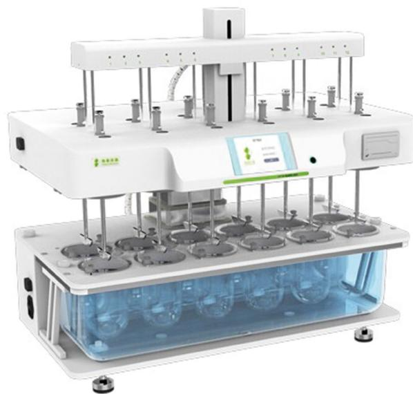
3. Модель **DT12**. Функционал данного прибора идентичен модели DT08, однако дополнен большим количеством сосудов для растворения (12 сосудов), что позволяет анализировать единовременно 12 образцов или 2 серии по 6 образцов параллельно в идентичных условиях. Модель DT12 спроектирована для лабораторий с большим количеством тестов.
