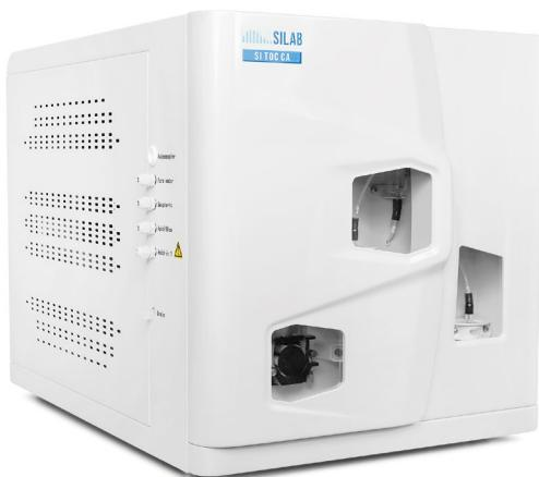
Модель **SI-TOC Line** работает по принципу УФ-окисления пробы и измерения электропроводности для количественного определения общего органического углерода TOC. Для полного окисления
