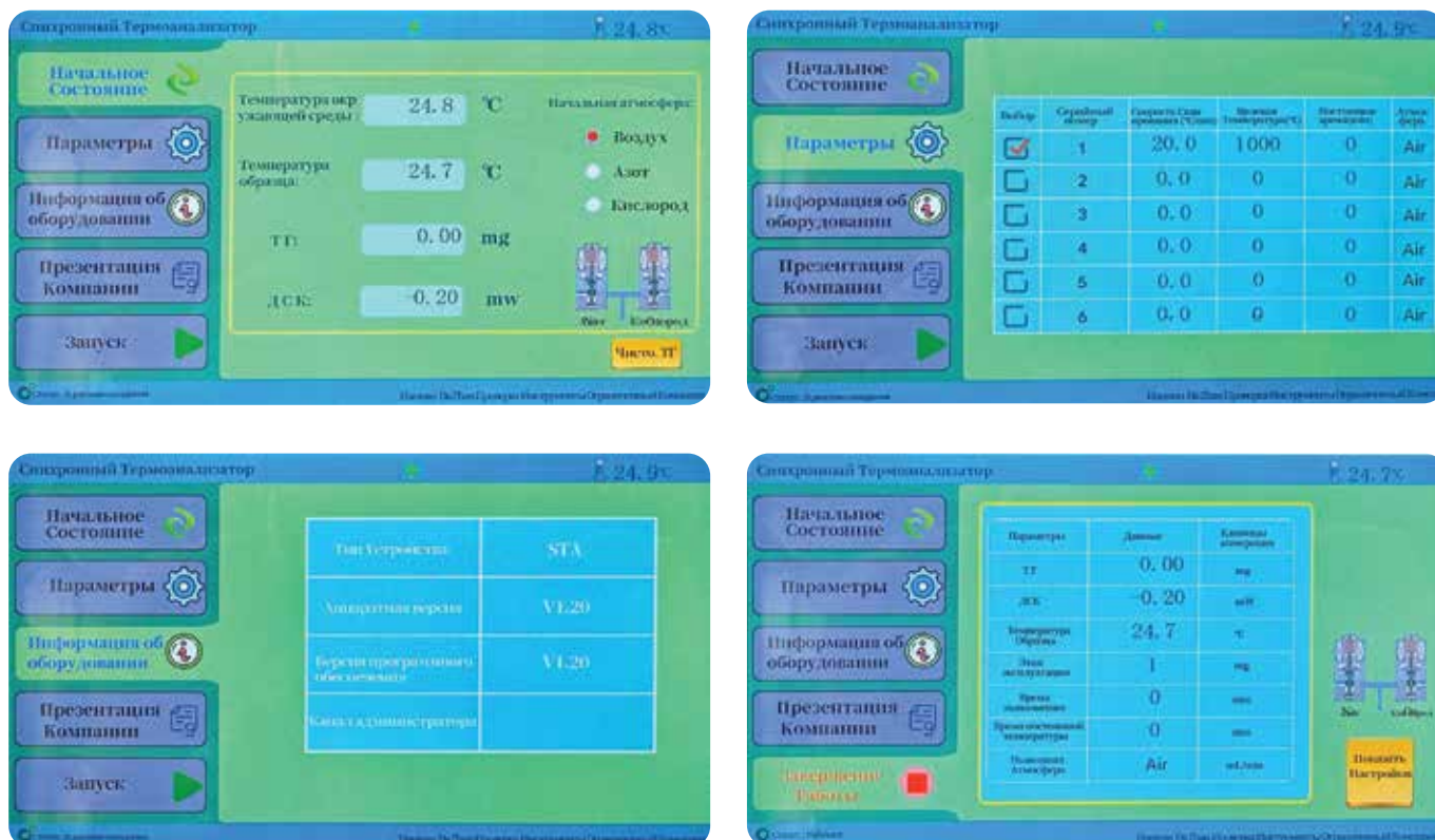
Рисунок 1 – Вид сенсорного дисплея приборов термоанализа
