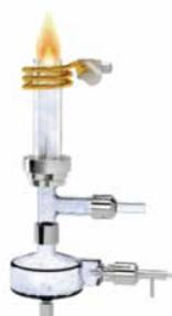
**Система для разбавления аэрозоля** образца аргоном, снижающая матричное влияние;
