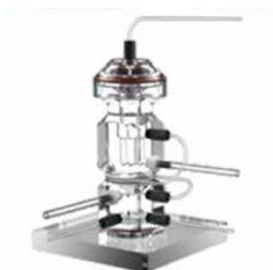
**Ртутно-гидридная приставка** для определения сверхнизких концентраций Hg, As, Se, Sb, Sn, Bi и Te;
