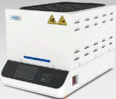
Системы HotBlock позволяют проводить нагрев растворов в сосудах для разложения микроволновых печей серии Tank.
